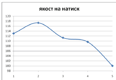
Фиг. 5. Графика на якостта на натиск в проценти на отделните състави
