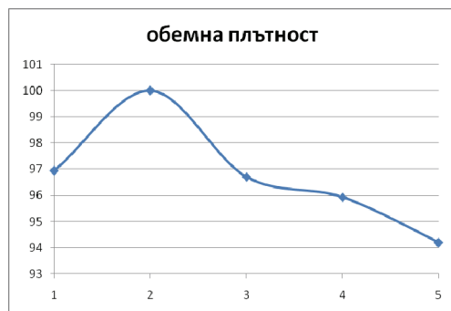
Фиг. 6. Графика на обемната плътност в проценти на отделните състави
