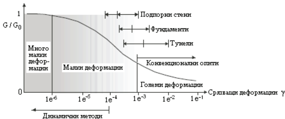
Фиг. 18. Типична крива на редукия на G модула за почва в зависимост от срязващите деформации и диапазони на деформациите при лабораторни опити и при конструкции [5]
