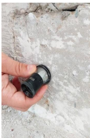
Фиг. 12. Измерване на широчината на пукнатина с мерна лупа
