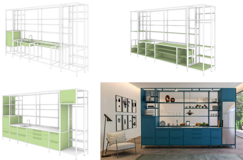
Фиг. 10. Структура и вариант на подредба на модулна кухня „Kitchen for life“ [23]
