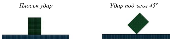
Фиг. 5. Основни възможни начини за падане/удар на противотежестен блок на кулокран върху етажна плоча на сграда
