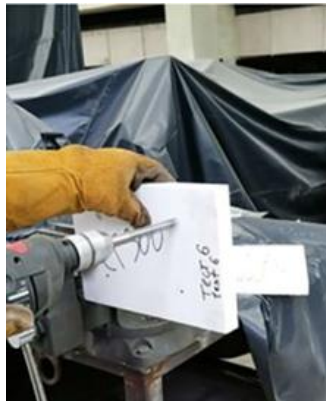
Фиг. 9. Механични характеристики на изолационна подложка от фирма “Compsfoam”, Австрия
