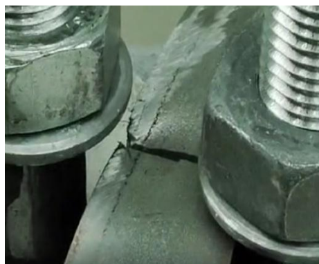
б) Тест 4 – бавно разпространение на пукнатите (Цикъл 13)
