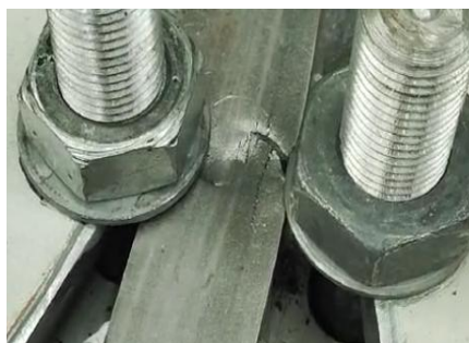
б) Тест 1 – ускорено разпространение на пукнатините (дърпане на актуатора)
