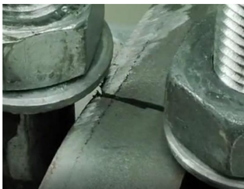
а) Тест 4 – бавно разпространение на пукнатите (Цикъл 12)
