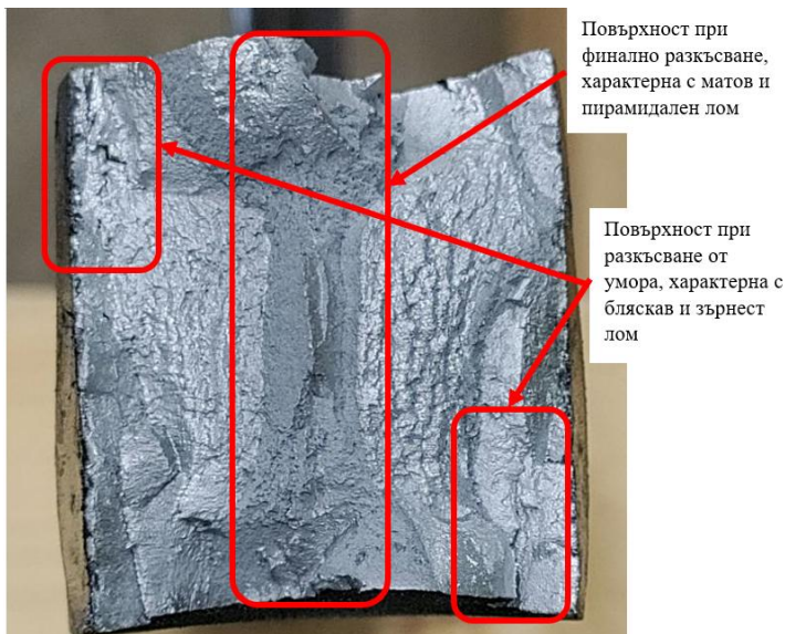
Фиг. 7. Видове повърхност след разрушение от екстремно-нискоциклична умора
