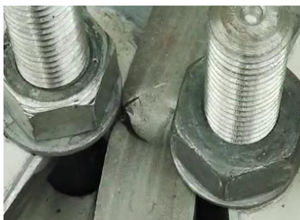
а) Тест 1 ускорено разпространение на пукнатините (бутане на актуатора)
