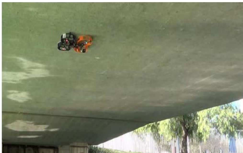
Фиг. 5. Дрон за измерване на собствени честоти, закрепен към конструкцията [17]
