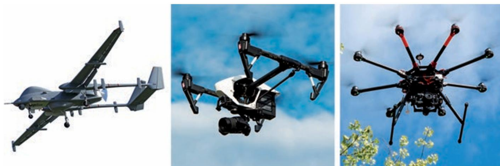
Фиг. 1. Безпилотни летателни апарати, различаващи се по вида на задвижване от ляво надясно – летящ с крило “IAI Heron”, “DJ Inspire” с четири ротора, роторен “DJJ Spedings Wings” с 8 ротора [1]
