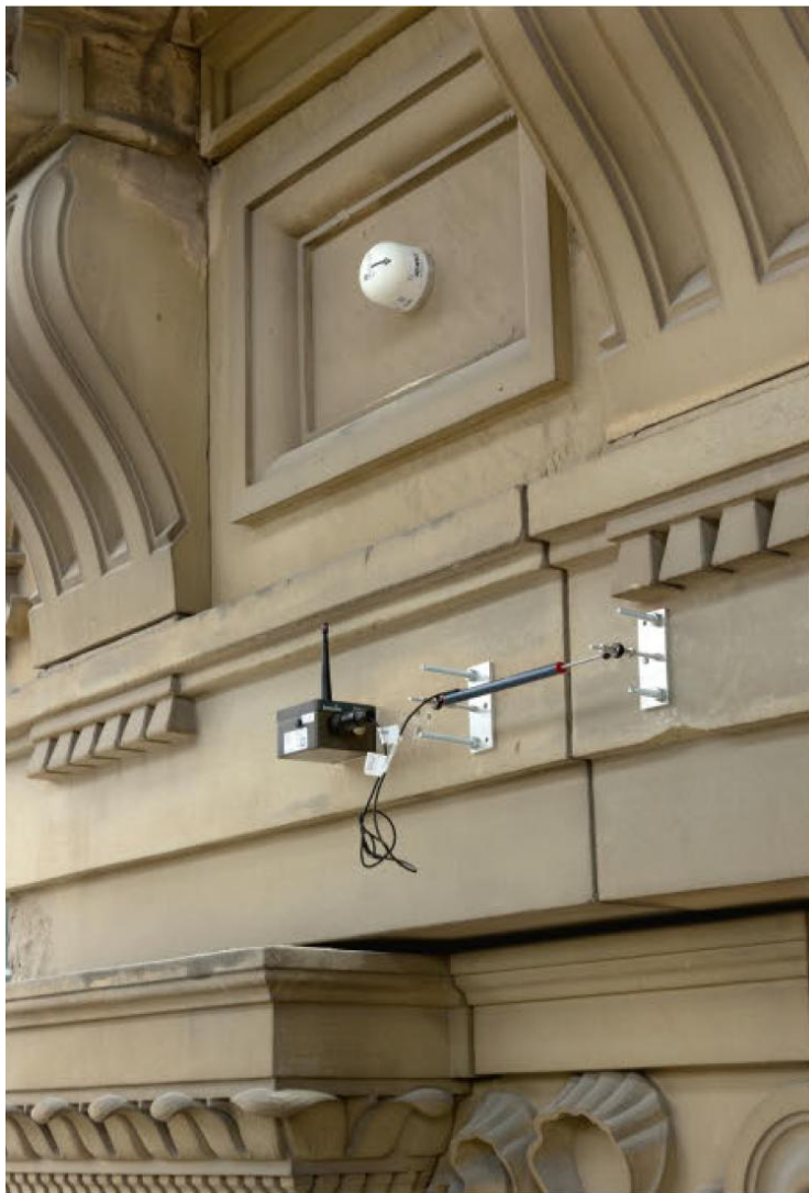
Фиг. 2. Безжични деформометри – тип индуктивни датчици [9]
