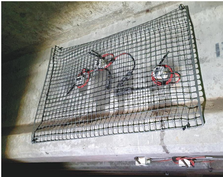
Фиг. 1. Индуктивни датчици, монтирани на мостова греда [5]
