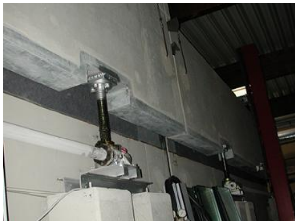
Фиг. 1. Стенд за изпитване с повдигащ се таван и уред за измерване Nordsonik 830
