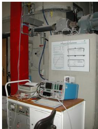
Фиг. 1. Стенд за изпитване с повдигащ се таван и уред за измерване Nordsonik 830
