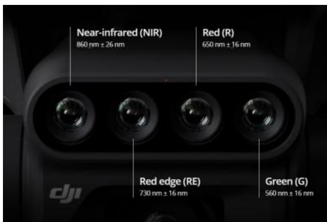
Фиг. 4. Мултиспектрален сензор, използван на БЛС “DJI Mavic 3M” [2]
