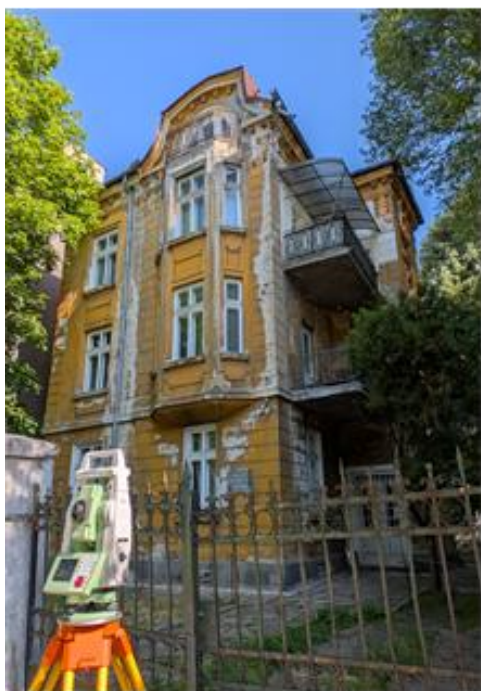
Фиг. 2. Създаване на работна геодезическа основа и измерване на опорни точки (вляво), геодезическа снимка на терен и прилежаща ситуация (вдясно)
