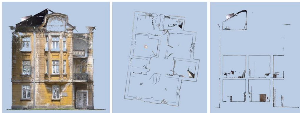
Фиг. 9. Вляво – фасаден план, в средата – хоризонтален разрез, вдясно – вертикален разрез
