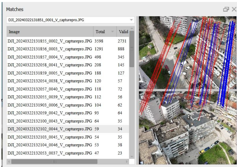
Фиг. 8. Свързващи точки и връзки между точки от изображенията
