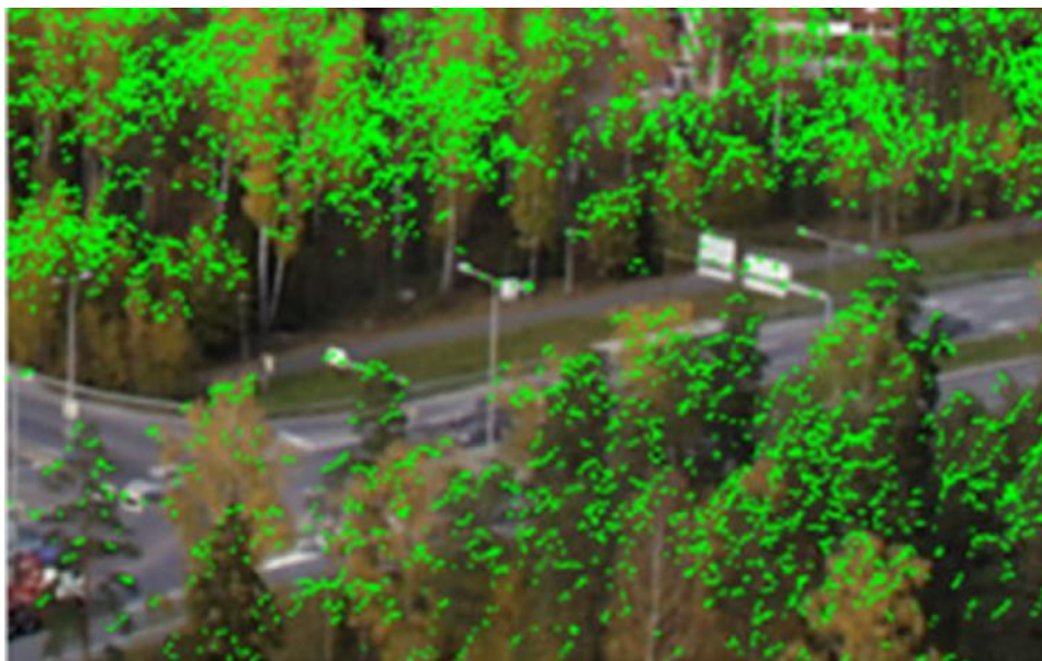
Фиг. 2. Комбинация на модел от изображения с класифициран облак от точки клас „растителност“, получен от LiDAR
