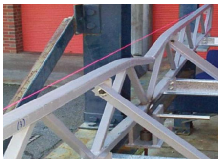
Фиг. 2. Загуба на устойчивост на натиснатия пояс в равнината на фермата (вляво) и извън нея (вдясно) при укрепяването му с подкоси ( Patnaik & Srivatsan [1])
