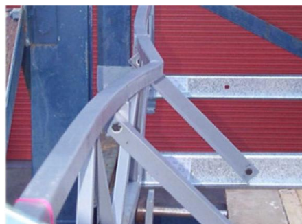
Фиг. 2. Загуба на устойчивост на натиснатия пояс в равнината на фермата (вляво) и извън нея (вдясно) при укрепяването му с подкоси ( Patnaik & Srivatsan [1])
