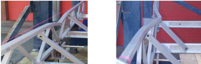
Фиг. 2. Загуба на устойчивост на натиснатия пояс в равнината на фермата (вляво) и извън нея (вдясно) при укрепяването му с подкоси (Patnaik & Srivatsan [1])
