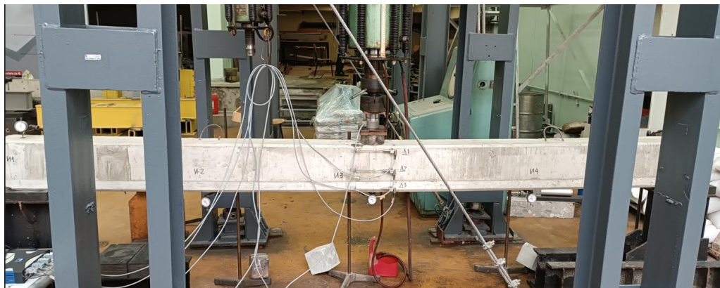
Фиг. 4. Експериментална постановка на неусилената греда
