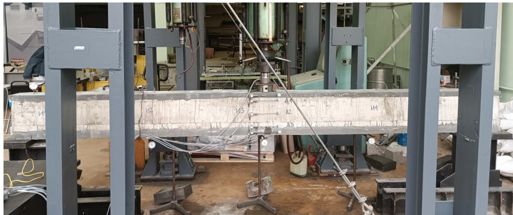
Фиг. 5. Експериментална постановка на усилената греда
