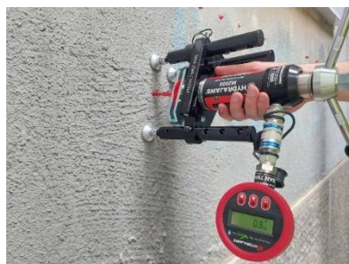
Фиг. 12. Изпитване на дюбели при натоварване на опън във фасадни панели
