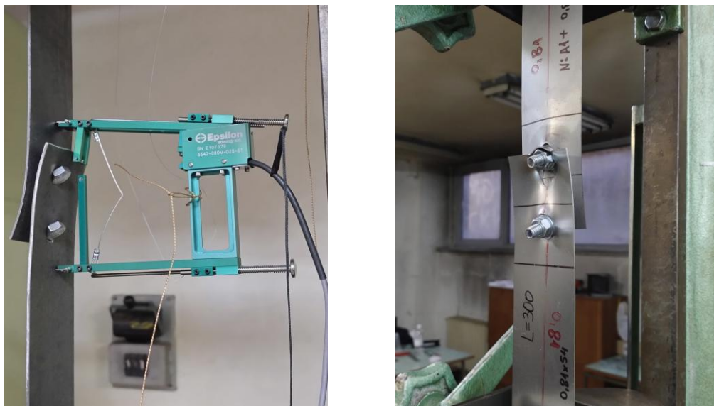
Фиг. 8. Опитна постановка за определяне на носимоспособността на еднорезно болтово съединение
