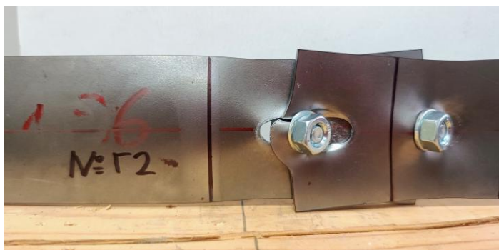
б) надлъжно разцепване на краищата на образците
