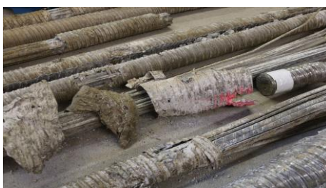
Фиг. 5. Напъгащата армировка от моста [5]
