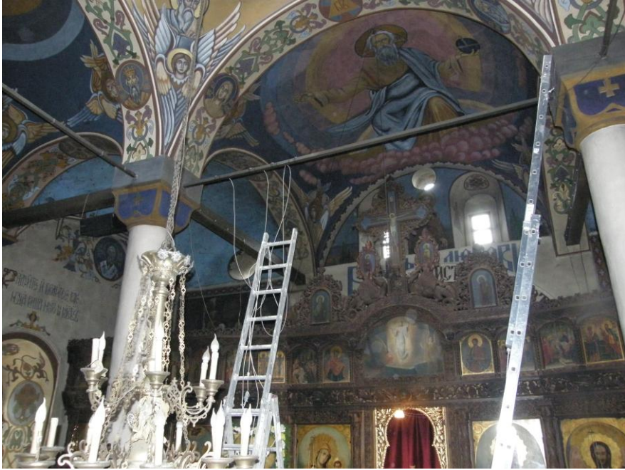
Фиг. 3. Общ вид на опитната постановка за БДИ на обтегач Нп-2
