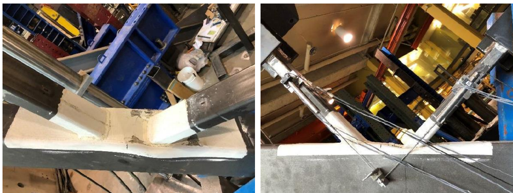
Фиг. 1. Възел KG1 при разрушаването му [6]
