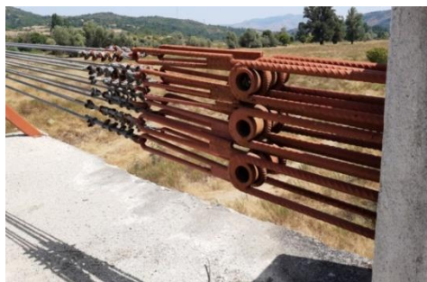
Фиг. 9. Начини на закотвяне на въжетата
