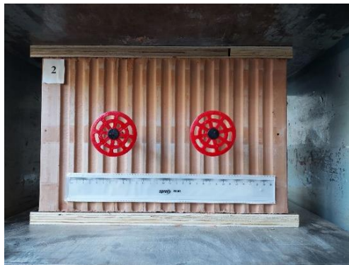
Фиг. 7. Общ вид на монтираните дюбели [фотография: инж. И. Цонев]
