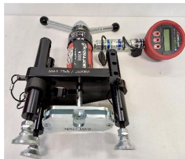
Фиг. 3. Общ вид на уред за определяне на носимоспособността на опън [фотография: И. Цонев]
