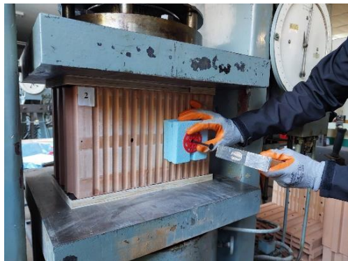
Фиг. 6. Монтиране на дюбели в блокове за зидария „Тип 2“ [фотография: И. Цонев]
