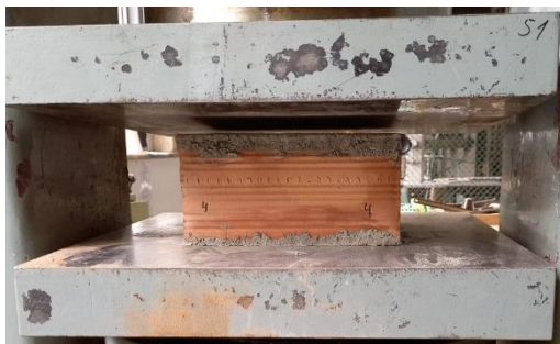
Фиг. 2. Определяне якостта на натиск на блок за зидария „Тип 4“ [фотография: И. Цонев]
