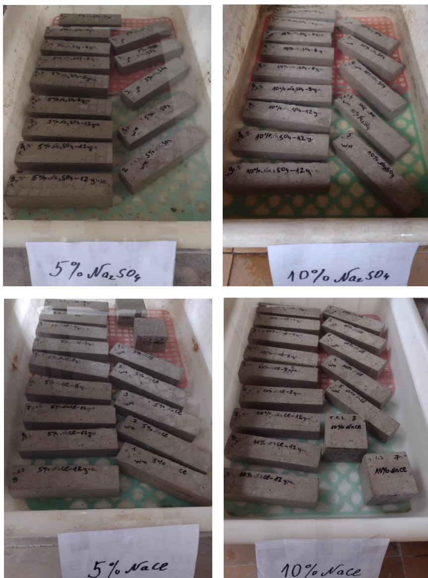
Фиг. 1. Трегирание на пробните тела от ОБ и ВЯБ в 5 % и 10 % водни разтвори на NaCl на Na 2 SO 4
