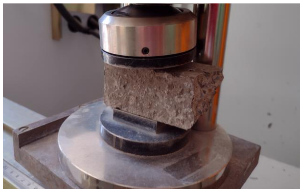
Фиг. 3. Опитна постановка при изпитване на натиск
