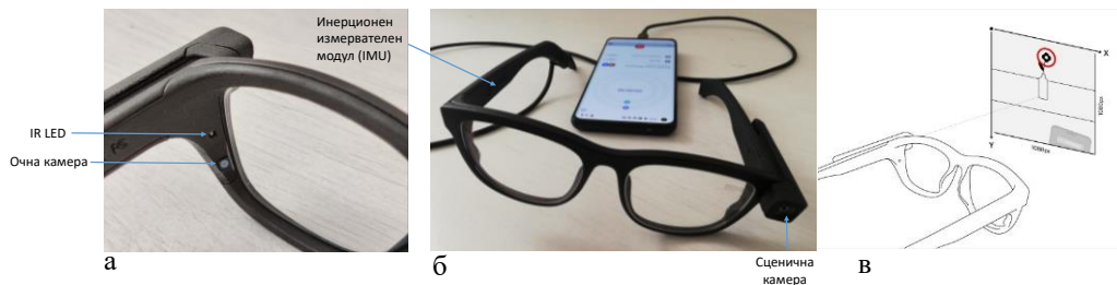
Фиг. 1. Очила за измерване на поведението на погледа Pupil Invisible
