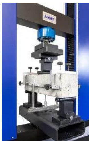
Фиг. 4. Машина eXpert 2654 за изпитване на образци съгласно EN 14651, оборудвана за изпитване на циментови образци с датчик CMOD [5]
