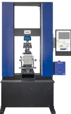
Фиг. 4. Машина eXpert 2654 за изпитване на образци съгласно EN 14651, оборудвана за изпитване на циментови образци с датчик CMOD [5]
