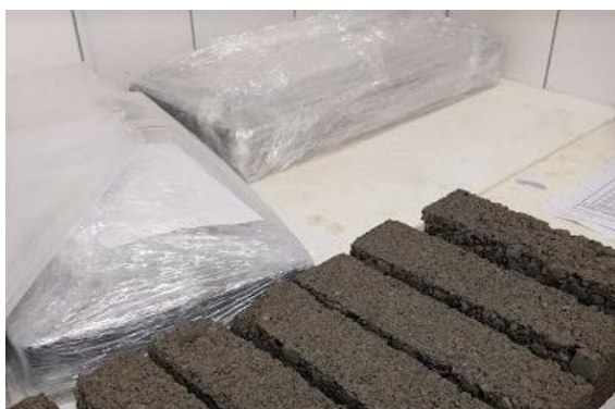
Фиг. 1. Опаковани плочи, набиращи якост (ляво – горе) и пряно нарязани призматични пробни тела (дясно – долу) във влажна камера
