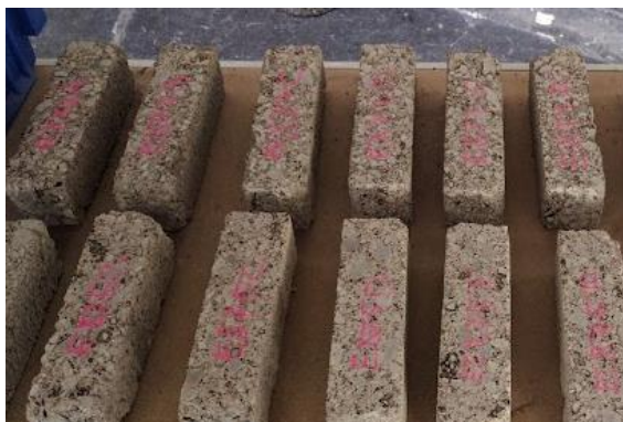
Фиг. 2. Призматични пробни тела за определяне на обемната плътност
