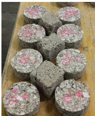
Фиг. 3. Цилиндрични пробни тела за определяне на обемната плътност
