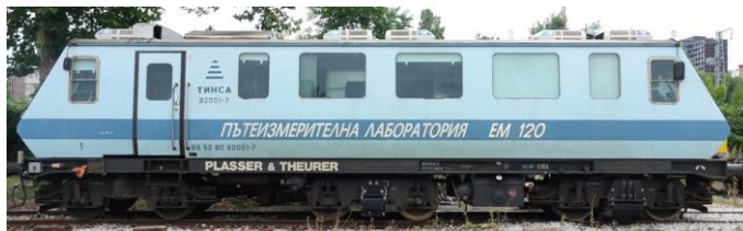
Фиг. 2 Пътеизмерителна лаборатория EM-120
