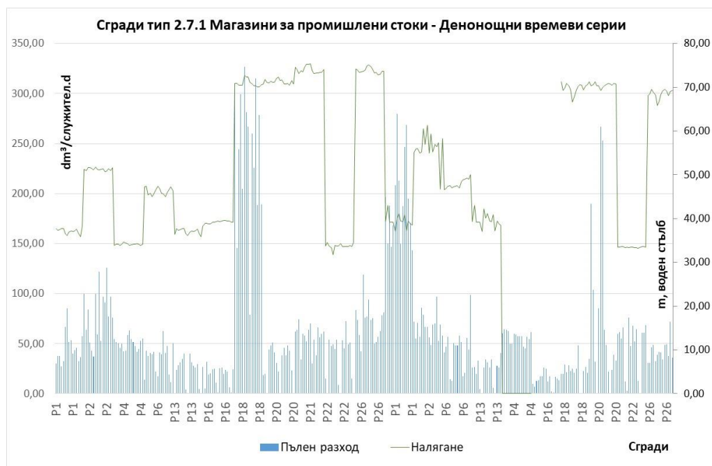
Фиг. 2. Денонощни времеви серии на измереното водопотребление и налягане за магазини за промишлени стоки
