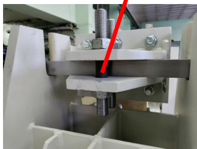
а) захващане на експерименталния образец към натоварващата глава
