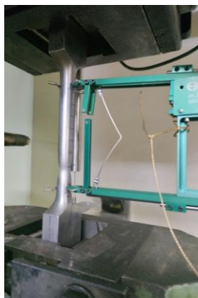
в) момент на образуване на „шийка“
