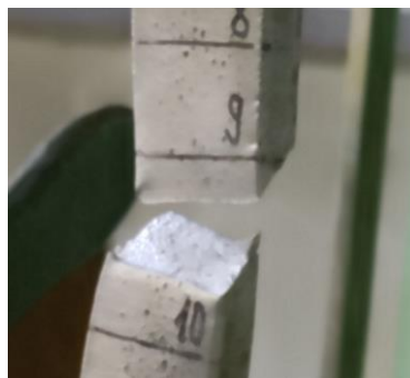
г) структура на стоманата при разрушение
