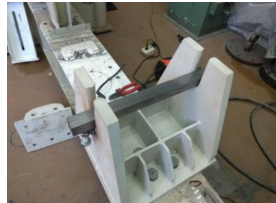
б) изглед на закрепването на пробния елемент към опората
