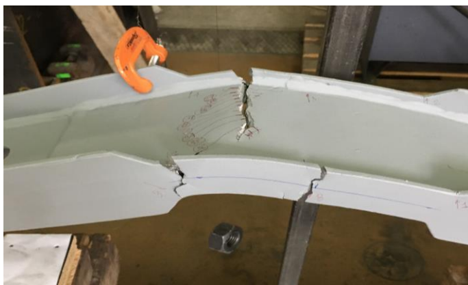
Фиг. 1. Разрушаване на модифицирани диагонали, следствие на екстремно-нискоциклична умора. Изследването е проведено в УАСГ от Георгиев и колектив [1]
