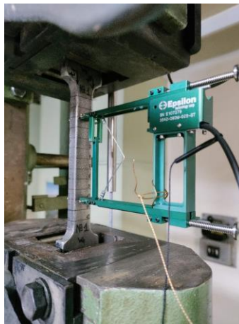
б) екстензометър с база 80 mm
