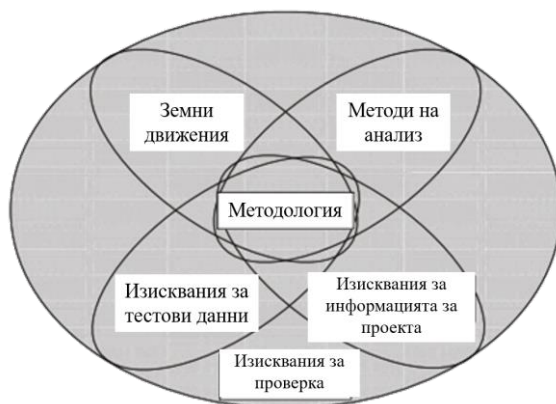
Фиг. 2. Основни компоненти на методиката за количествена оценка на коефициентите, характеризиращи сеизмичното реагиране на строителни конструкции съгласно FEMA P695 [16]
