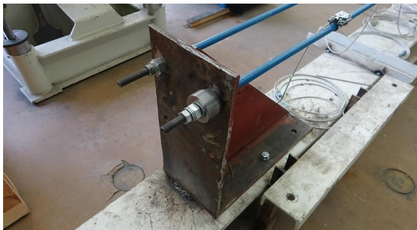
Фиг. 2. Ляв опорен край на обтегача със сферична става
