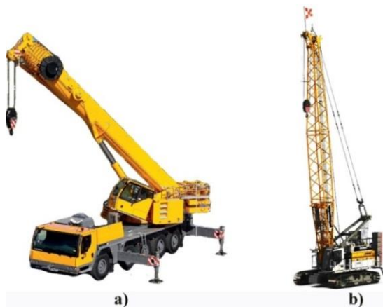
Фиг. 1. Основни възможни варианти за избор на тежък самоходен кран за строителни и монтажни работи a) пневмоколесен; b) верижен
