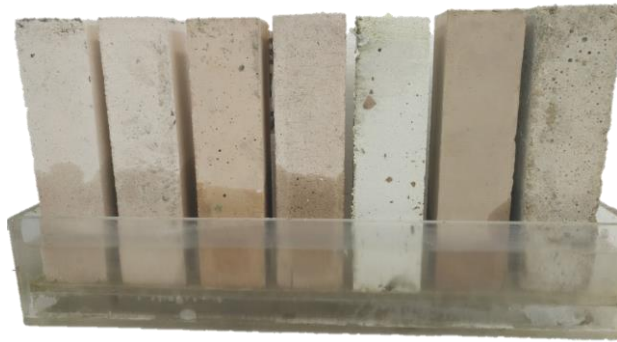
Фиг. 3. Снимка на опитната постановка за изследване на капилярна водопопиваемост [6]
