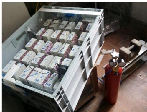
Фиг. 1. Опитна постановка за осъществяване на ускорена карбонизация
