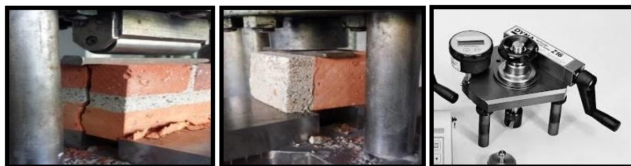
Фиг. 13. Определяне на якостта на опън на сцепление на зидарийния разтвор
