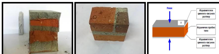
Фиг. 12. Пробни тела с автентичен варов разтвор между тухлите
