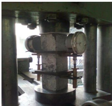
Фиг. 1. Изпитване Е-модул на пробни тела призми 40/40/160 mm
