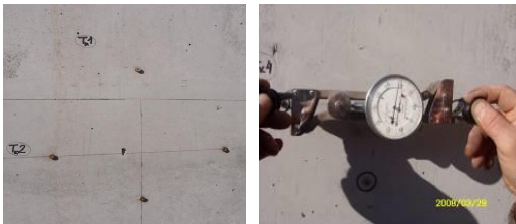
Фиг. 5. Поставени бази и взимане на нулеви отчети на относителните деформации в колони 12
