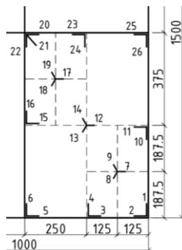
Фиг. 5. Разположение на тензометрични схеми по горната повърхност на черупката
