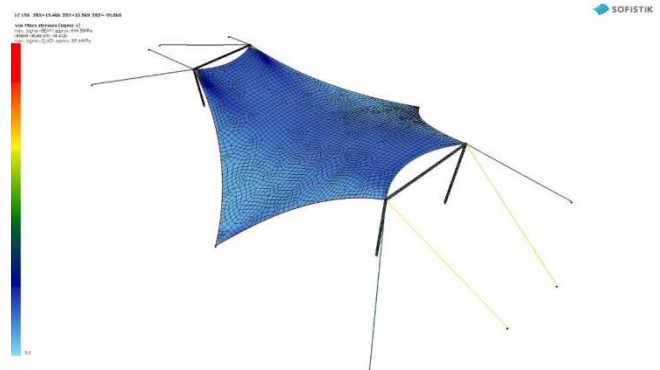
Фиг. 6. Резултати от статически нелинейни решения: а) напрегната конструкция, б) несиметричен сняг и вятър с коефициент за съчетание, в) несиметричен сняг с коефициент за съчетание и вятър
