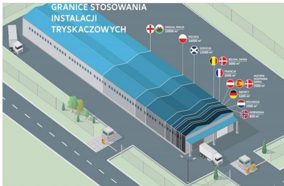
Фиг. 1. Максимално допустими площи на пожарни сектори без АПГИ в редица европейски държави по данни на застрахователната компания Allianz [4]
