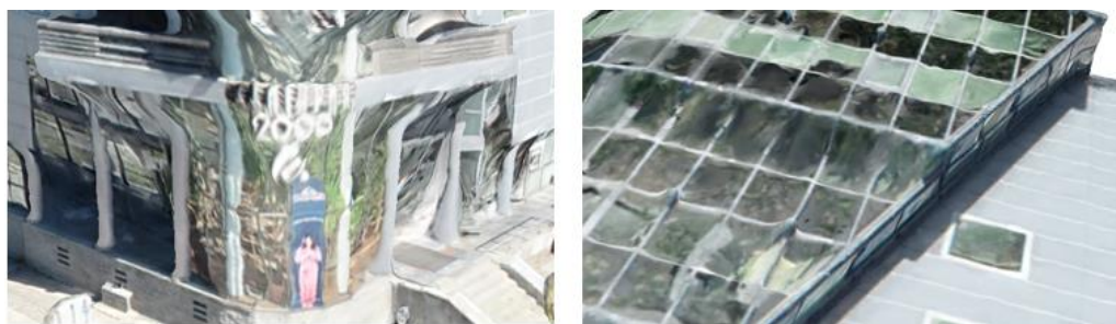
Фиг. 12. Недостатъци на 3D модела, получен чрез въздушно заснемане с БЛА
