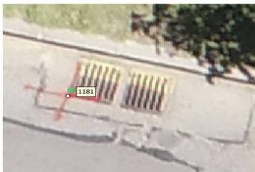
Фиг. 7. Въвеждане и маркиране на наземни контролни точки
