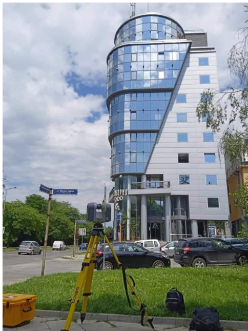
Фиг. 6. Измерване с наземен лазерен скенер
