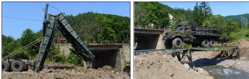
Фиг. 6. Работен момент от полагане на автомобилен механизирани мост по технология „назад“ над р. Батулийска, с. Батулия, август 2014 г.
