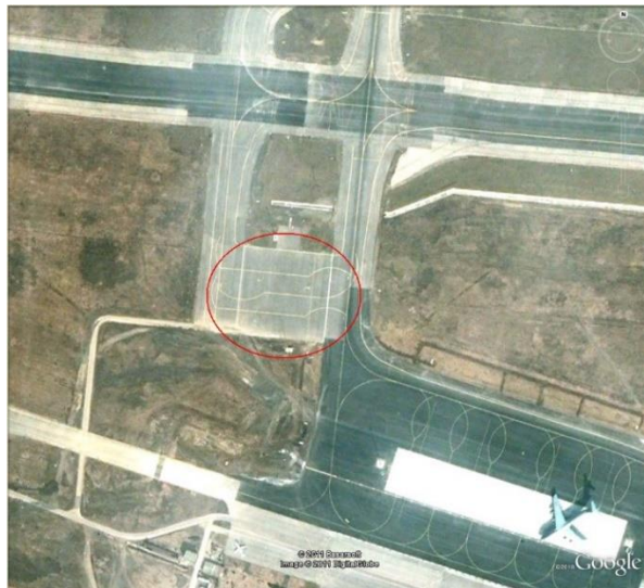
Фиг. 5. Северна противообледенителна площадка на летище София, изследвана за компенсационна площадка за калибриране на резервните компасни системи на самолети
