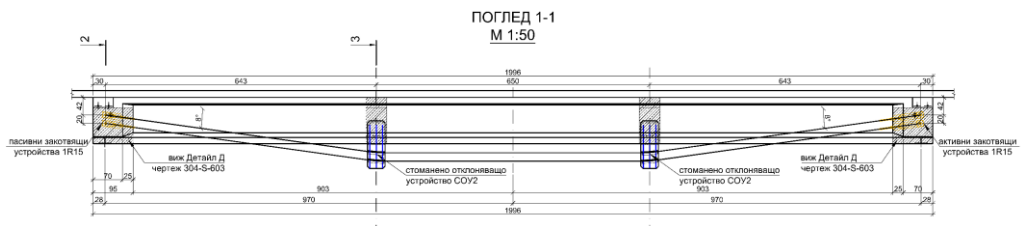
Фиг. 27. Възстановяване на предварително напрегане, чрез външно напрегане
