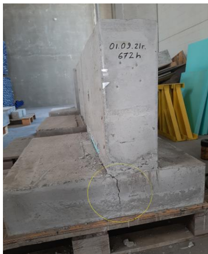
Фиг. 13. Констатирано разрушение на образца за изпитване на срязване на възраст 28 дни
