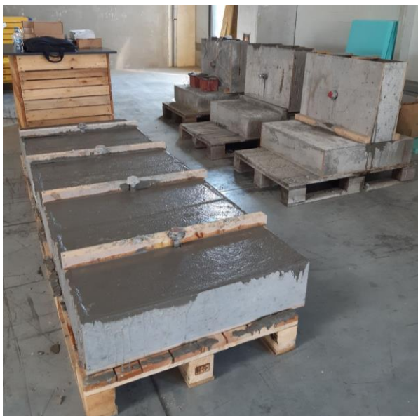
Фиг. 3. Общ вид на изпълнени и бетонирани образци със заложените към тях анкерни устройства
