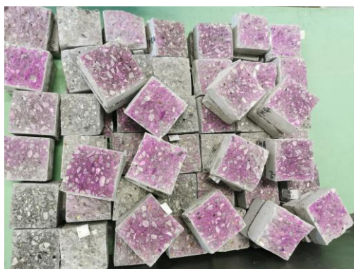
Фиг. 4. Карбонизирали пробни тела
