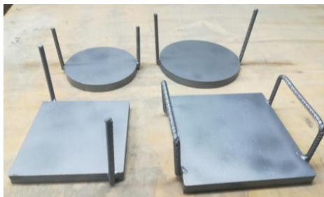
Фиг. 2. Кръгли и квадратни стоманени моделни фундаментни образци (натискови плочи) с размери \text{Ø}160 \text{ mm} , \text{Ø}200 \text{ mm} , 160/160 \text{ mm} и 200/200 \text{ mm}
