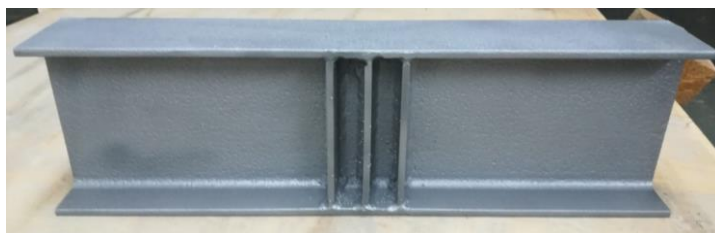
Фиг. 4. Товароразпределяща греда (със сечение IPE 160, L = 560 \text{ mm} )
