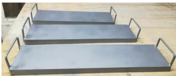
Фиг. 3. Правоъгълни стоманени моделни фундаментни образци (натискови плочи) с размери 160/560 \text{ mm} , 160/640 \text{ mm} и 160/720 \text{ mm}
