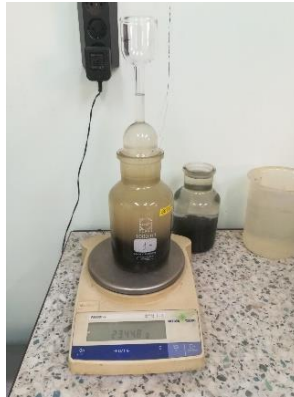
Фиг. 7. Определяне на максималната плътност – пикнометър
