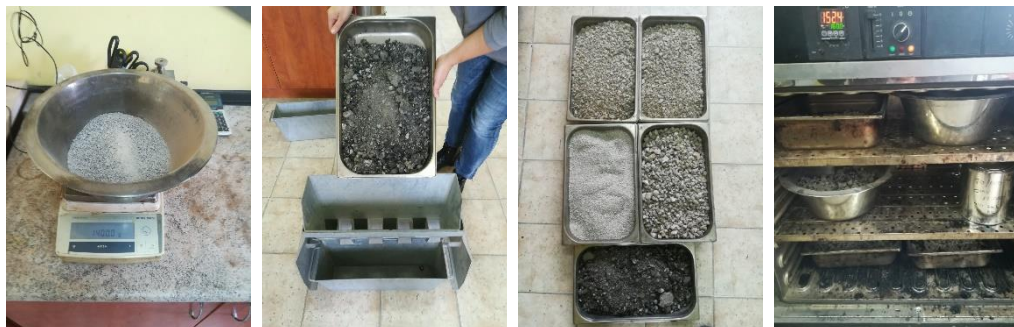
Фиг. 6. Подготовка на материалите – дозиране, квартуване, загряване
