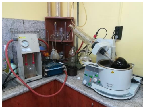
Фиг. 3. Възстановяване на битумно свързващо вещество чрез ротационен изпарител
