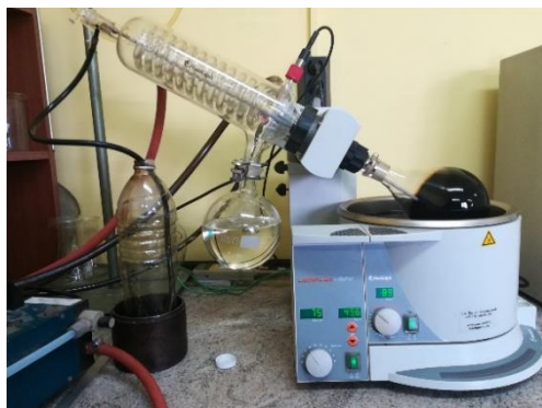
Фиг. 3. Възстановяване на битумно свързващо вещество чрез ротационен изпарител
