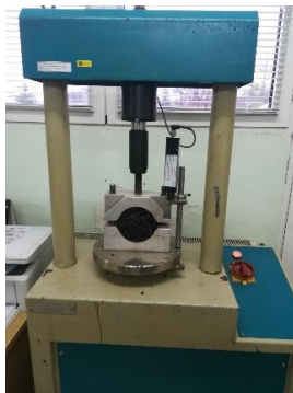
Фиг. 8. Определяне на устойчивост и условна пластичност по метода на Marshall
