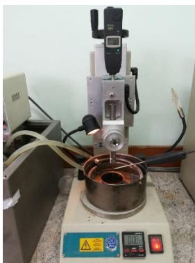
Фиг. 4. Определяне на пенетрация чрез пенетрометър
